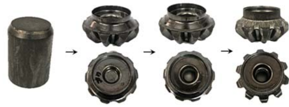
(a)Upsetting (b) Forging (c) Piercing (d) Trimming
